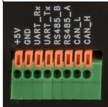
**+5V, GND** позволяют подать питание на дополнительное устройство (например датчик).
