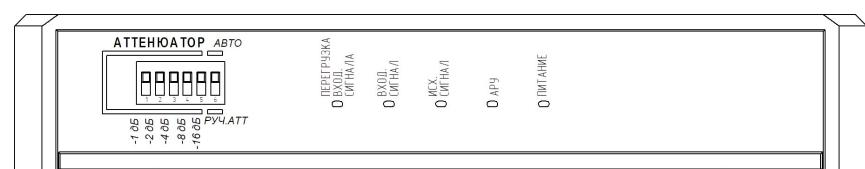
Переключателями № 1-5 АТТЕНЮАТОР устанавливается уровень ослабления входного и исходящего сигнала. Верхнее положение переключателей – выключено, нижнее положение – ослабление сигнала включено. Значения переключателей составляют -1; -2; -4; -8; -16 дБ, что соответствует ослаблению сигнала в 1,3; 1,6; 2,5; 6,3 и 40 раз. Одновременное включение нескольких переключателей приводит к суммированию соответствующих значений.
